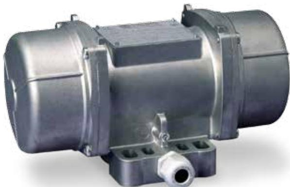
Progettata per il servizio industriale continuo, la serie M3 si caratterizza per la scatola morsettiera posizionata sotto al motovibratore per ottenere minori dimensioni di ingombro, un design più compatto e un'elevata protezione dei contatti elettrici. Il fissaggio multiforo consente ai motovibratori M3 di adattarsi a diversi interessi di foratura.
