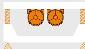
Per tavoli per compattazione e per test (invecchiamento accelerato, stress, ecc.): metodo unidirezionale.
