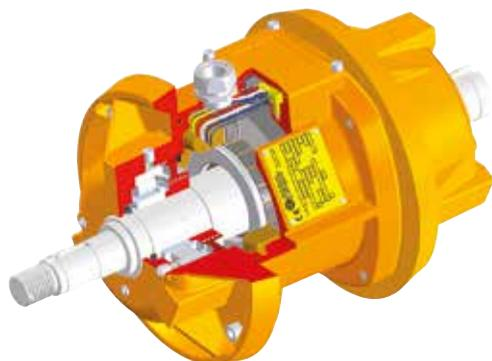
Il collegamento elettrico deve essere effettuato attraverso gli appositi connettori inseriti all'interno della scatola collegamenti. Speciali pressafili sagomati consentono di fissare il cavo di alimentazione, proteggendolo dalle vibrazioni.
