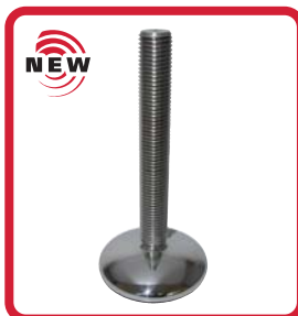
Part. R0749 - Pag. R50 Ø 120 • Acciaio inox • Sanificabile • Carico max. 50000 N.
