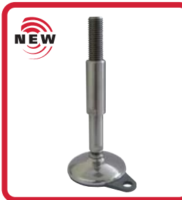
Part. R0750SF - Pag. R49 Ø 80 • Acciaio inox • Sanificabile • Predisposto al fissaggio • Carico max. 25000 N.
