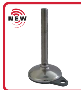
Part. R0748F - Pag. R45 Ø 100 • Acciaio inox • Sanificabile • Predisposto al fissaggio • Carico max. 25000 N.
