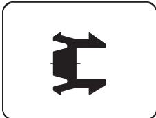
Part. S0370 - Pag. S74 Profilato di chiusura per Part. S0422. Migliora la pulizia.
