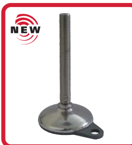
Part. R0747F - Pag. R45 Ø 80 • Acciaio inox • Sanificabile • Predisposto al fissaggio • Carico max. 25000 N.
