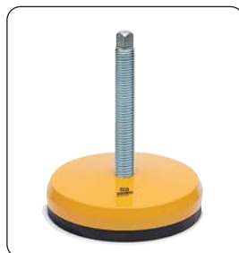
Part. R0406 - Pag. R55 Ø 123 • Acciaio verniciato • Carico max. 50000 N.
