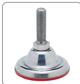
Part. R0385 - Pag. R56 Ø 110 • Acciaio inox • Sanificabile • Carico max. 10000 N.
