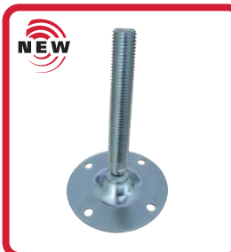
Part. R0349 - Pag. R42 Ø 123 • N. 4 fori • Acciaio inox e zincato • Carico max. 10000 N.
