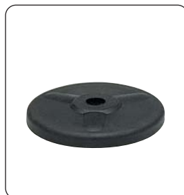
Part. R0055 - Pag. R59 Ø 110 • Gomma con rinforzo in acciaio • Carico max. 6000 N.
