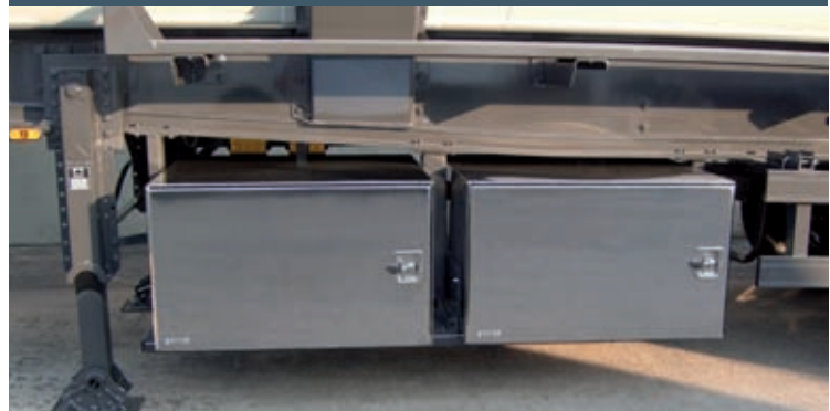
Allestimento con montaggio di due cassette BAWER 37 MONO, con apertura laterale.
