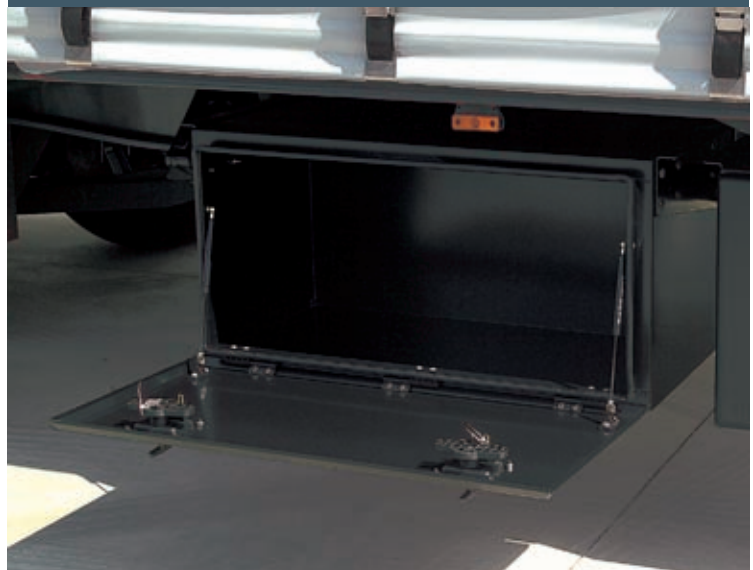
Allestimento con montaggio su semi-rimorchio di una cassetta BAWER 25 DUO (Vista cassetta aperta).
