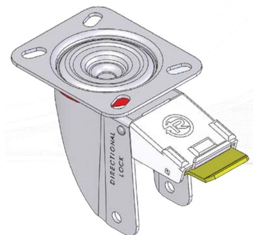
Il freno direzionale è integrato nel supporto rotante. E' idoneo per carrelli a traino manuale o carrelli a traino meccanizzato a bassa velocità (massimo 6 km/h) su pavimentazione in buone condizioni. Per facilitarne l'utilizzo, è dotato di auto inserimento nell'intaglio di direzionamento ruota presente sull'anello tenuta sfere dei supporti rotanti. Su richiesta è applicabile ai supporti tipo NL diametro 80-100-125-140/150.
