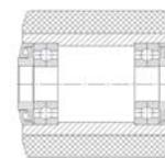
Labirinti: anelli di protezione in materiale plastico, montati ad interferenza davanti ai cuscinetti a sfere. Ne garantiscono la durata nel tempo, proteggendoli dalla polvere e dai corpi estranei che possono limitare la libertà di rotazione del rullo.
